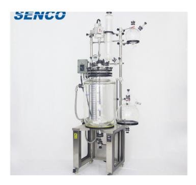
开盖式夹套玻璃反应釜的寿命延长,保障设备正常运行,用户也需要注意设备的定期维护和保养。在日常维护的方法中,例如,定期检查仪器各接口是否吻合,注意轻拿轻放;各接口不可拧得太紧,要定期松动活络,避免长期紧锁导致连接器咬死;用软布擦拭各接口,然后涂抹少许真空脂;定期对密封圈进行清洁;各处的聚四氟开关不能过力拧紧,容易损坏玻璃;停机后拧松各聚四氟开关,长期静止在工作状态会使聚四氟活塞变形。此外,必须采购原厂配件,随意使用其他配件对机器会造成致命的损害[FC2003双层玻璃反应釜安装注意事项。天津操作方便FC2003双层玻璃反应釜哪个品牌好
