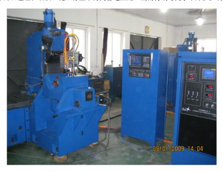
粉末等离子堆焊的主要工艺参数有: (1) 非转移弧电流:非弧首先起过渡引燃转弧的作用,并可作为辅助热源加以利用。非弧的阳极在喷嘴孔道壁面上,电弧的大部分热量传给喷嘴,由冷却水带走,不利于喷嘴的冷却,对堆焊过程稳定性不利。因此,堆焊过程中即或保留,电流规范也不宜过大,一般在50A以下。(2)转移弧电流:转弧是堆焊的主要热源,转弧电流是关键工艺参数。在其他参数不变的情况下,随着转弧电流的增加,电弧功率增加,加热熔化粉末及过渡到工件的热量增加,熔池温度升高,合金熔化得更充分,但熔深加深,增加了母材冲淡率。在设定好熔敷率后,要视熔池状况,调整好转移弧电流,以获得佳的堆焊质量。湖南肯纳等离子堆焊多少钱一台等离子堆焊的熔深可控,稀释率低。
