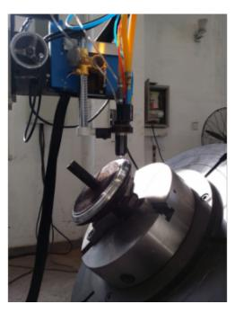
粉末等离子堆焊在石油机械行业的应用:早在粉末等离子堆焊技术开始推广应用初期,就成功应用于钻杆接头堆焊耐磨合金带,并在钻具修造行业推广,效果突出,效益明显。在钻采设备中,平板阀密封面采用粉末等
